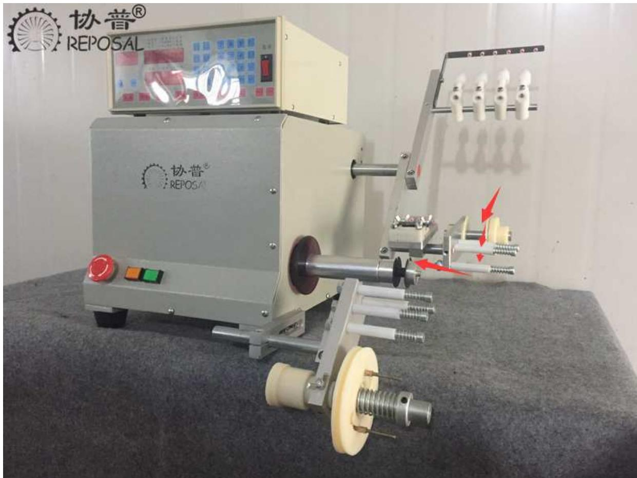
挡墙胶带控制安规要求的空间距离与爬电距离.其安装途径如上图.
